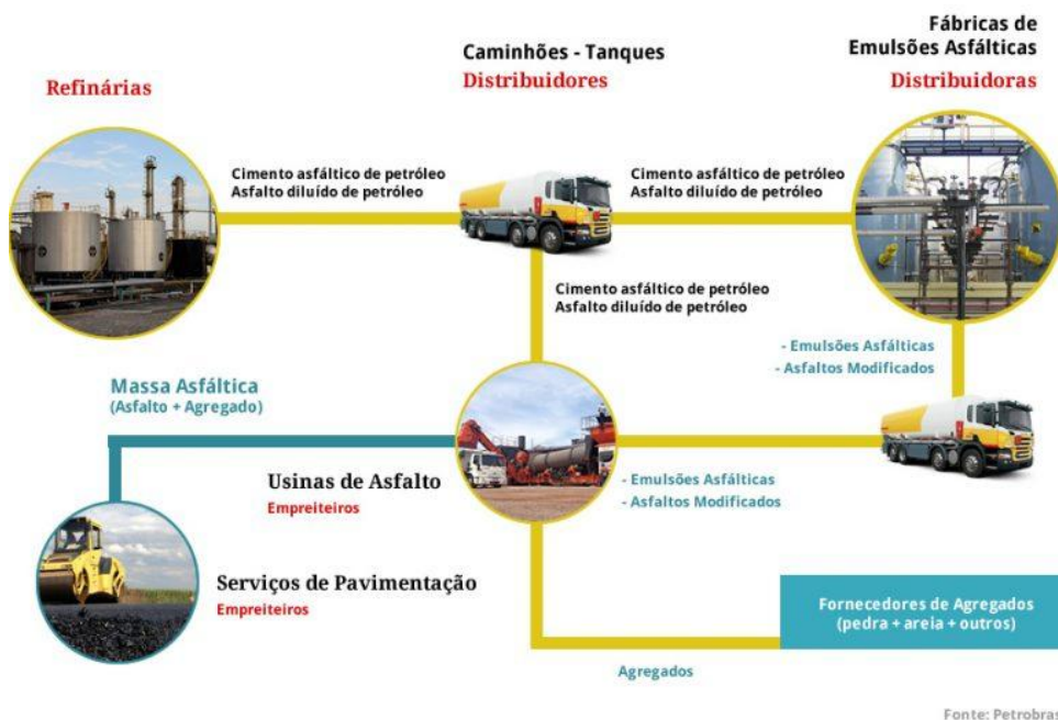
FIGURA 5: FLUXOGRAMA DO PROCESSO DE TRANSPORTE DOS INSUMOS ASFÁLTICOS
